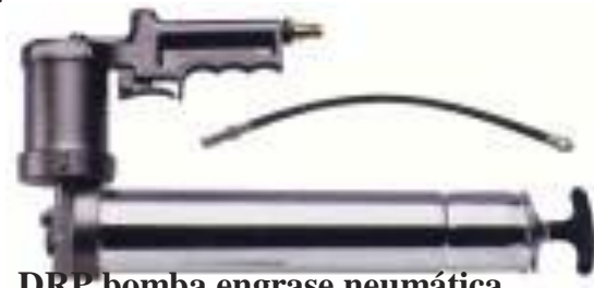
DRP bomba engrase neumática Suministro permanente. Máx. 250gr/min. sin contra presión. Presión salida 400 bar (5800 PSI), con válvula de rellenado. Zincada. Ref. 7436011, rosca: 1/8", latiguillo flexible doble trenza 500 mm con conector hidráulico 516/G.
